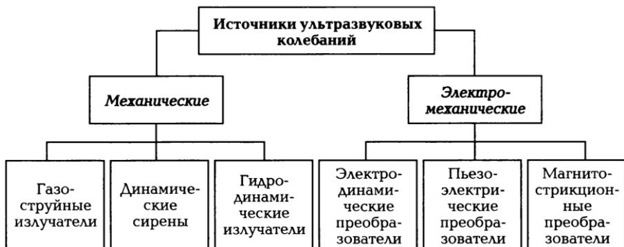
Рис. 4.11. Классификация источников ультразвуковых колебаний
